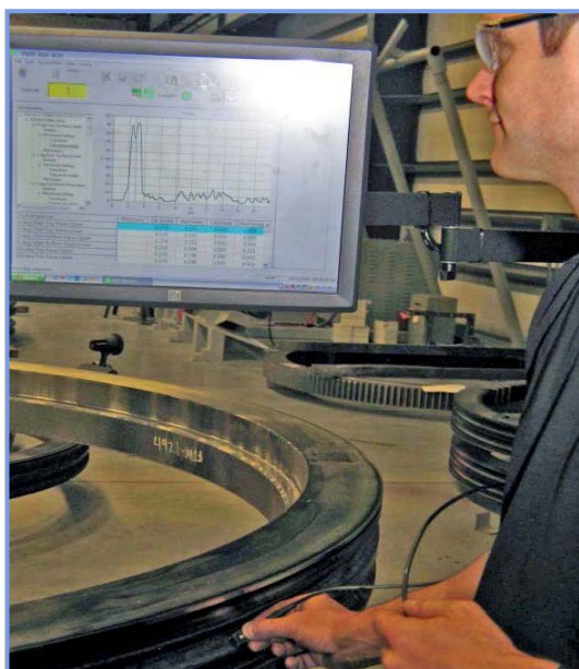
Figura 2 - Misurazione e rilevamento dati della profondità di tempra con spettrometro a ultrasuoni.
